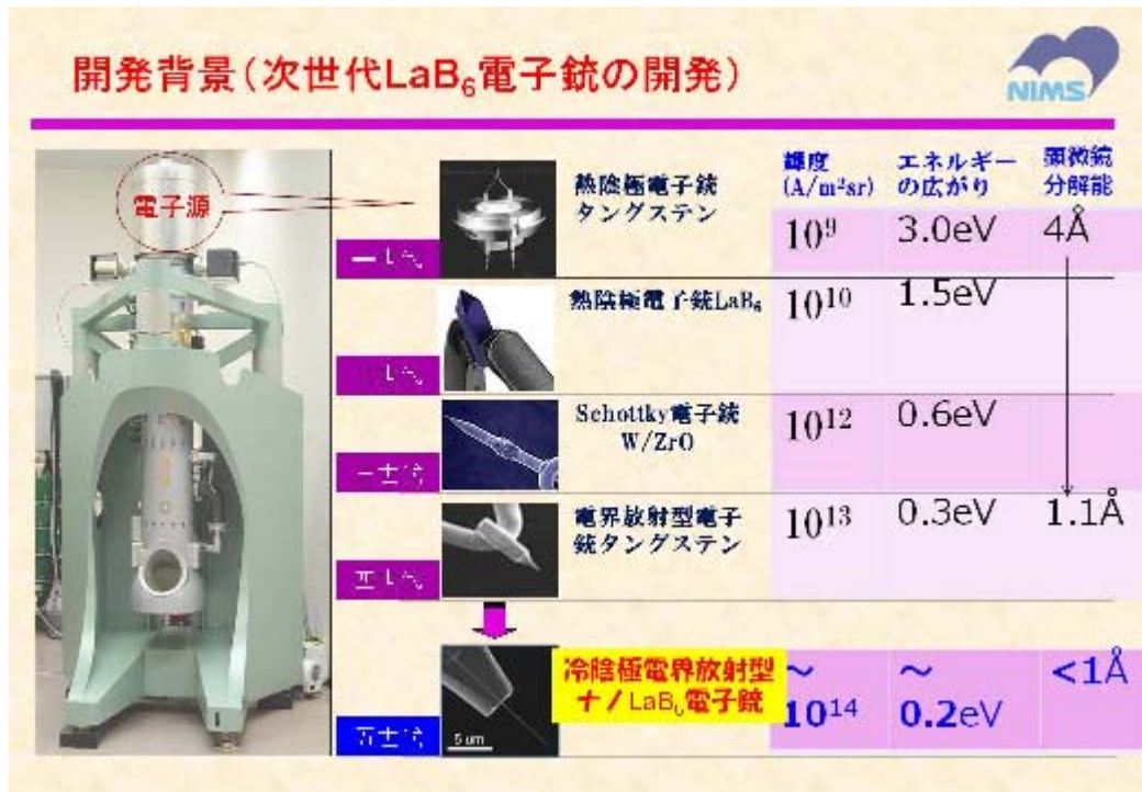
図1 電子源（ここでは電子源を組み込んだ電子銃）の発展過程と今後期待される次世代電子源
